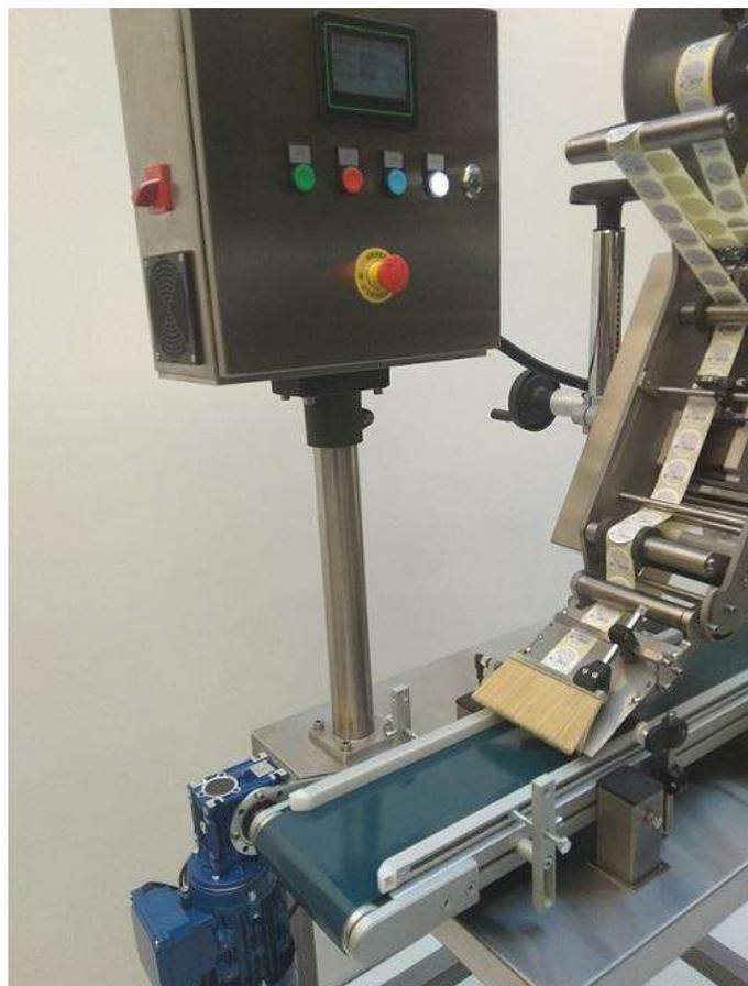
Cette machine est conçue pour déposer des étiquettes sur des surfaces planes avec la possibilité de basculer la tête pour travailler en mode “étiquetage latéral” ou en mode “étiquetage par dessus”
