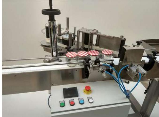
Cette machine est conçue pour étiqueter des récipients cylindriques tels que bouteilles, pots, flacons, etc...
