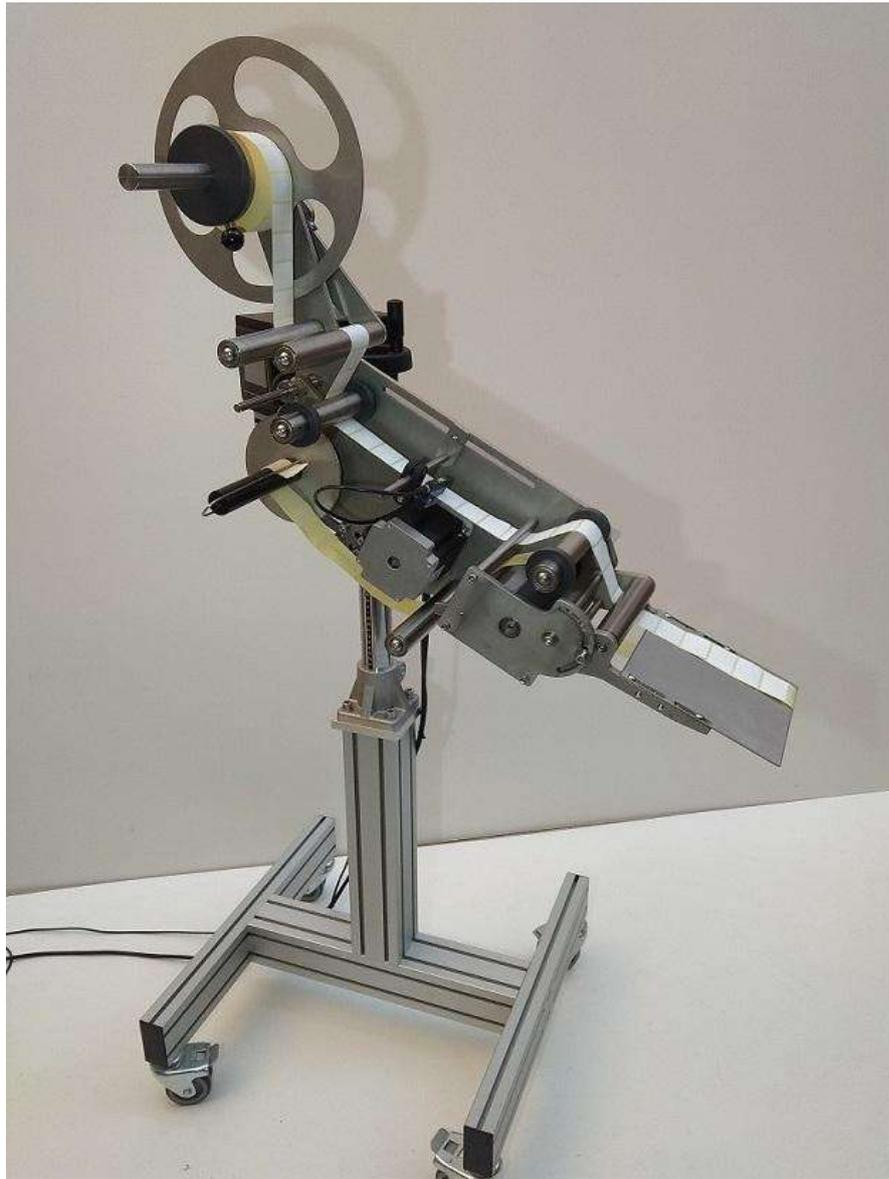
Cet ensemble tête de pose sur châssis mobile est idéal pour s'adapter sur des convoyeurs déjà existants. On peut le déplacer facilement et l'immobiliser, grâce à ses 4 roulettes giratoires avec frein.
